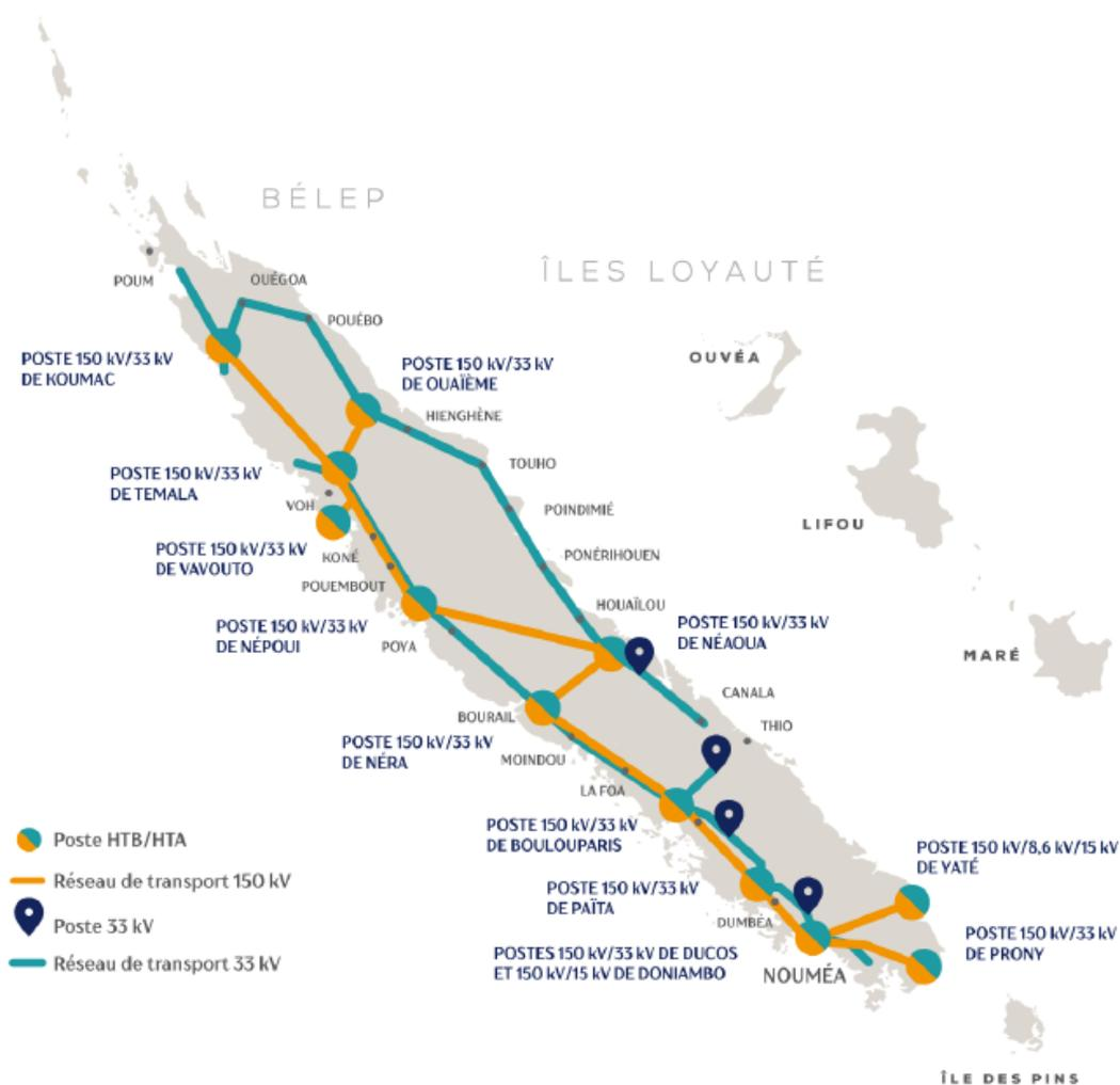
Figure 9 - réseau de transport d'électricité interconnecté de la Grande Terre - source ENERCAL
